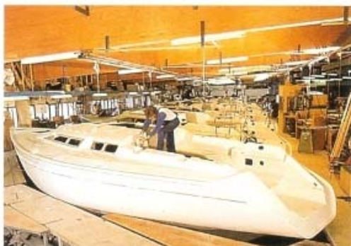
Endmontage am laufenden Band: Ähnlich wie in der Autoindustrie, werden die Teile auf einer Taktstraße kostengünstig montiert.
