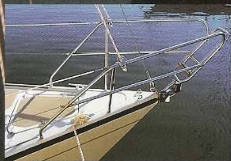
Eine herabklappbare Bugleiter erleichtert das Übersteigen. Dahinter ist die Luke der selbstlenzenden Ankerpiek zu sehen.
