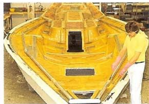
Die aufwendige Compositbauweise – hier sind Teile des Alurahmens zu sehen – sorgt bei geringem Gewicht für die extrem hohe Festigkeit.
