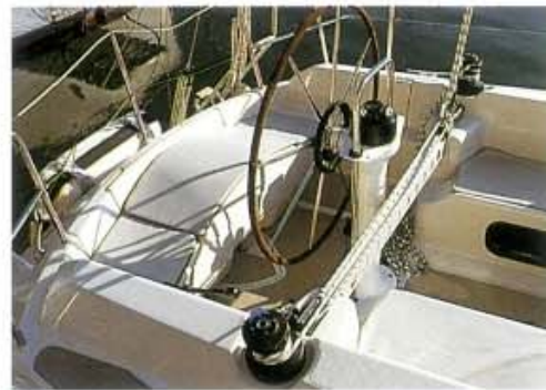
Separates Cockpit für den Steuermann – das große Steuerrad wirkt mit der Steuerungsbühnenstange sehr direkt auf das elliptische Ruder; ein Vorteil bei schnellen Manövern.
