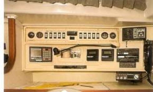
Elektronische Geräte lassen sich im großen Paneel über der Navigation einbauen.
