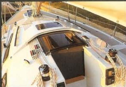
Bei fast allen Manövern kann die Crew im Cockpit bleiben, da sämtliche Fallen und Strecker nach achtern umgelenkt sind.
