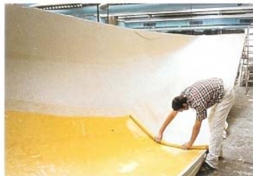
Rumpf und Deck werden im Handauflegeverfahren hergestellt. Für die DEHLER 38 wird zusätzlich das hochfeste Kevlar verarbeitet.
