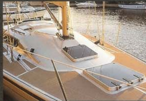
Alle Lewmar-Luken haben eine arretierbare Lüftungsstellung. Die vordere Luke ist so groß, daß sich Segel leicht im Vorschiff stauen lassen.
