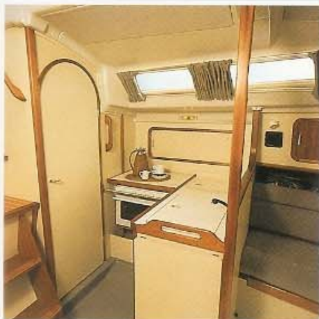
Pantry in NOVA-Ausführung: mit Doppelspüle, Lebensmittelbox, 3-fl. Gasherd mit Backofen. Hochklappbare Arbeitsfläche; wahlweise 75-l-Kompressor-Kühlschrank.
