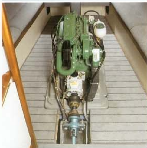
Als Einbaummaschine ist ein Dreizylinder-Viertakt Dieselmotor von Volvo-Penta mit 28 PS, oder der Turbo-Diesel mit 38 PS möglich. Beide Maschinen zeichnen sich durch ihre extreme Laufruhe aus, da sie direkt über dem Kiel auf besonders massiven Fundamenten stehen und mit einer Aquadrive-Wellenkupplung ausgerüstet sind. In den achteren Kabinen und im Cockpit ist daher vom Motor kaum etwas zu hören.
